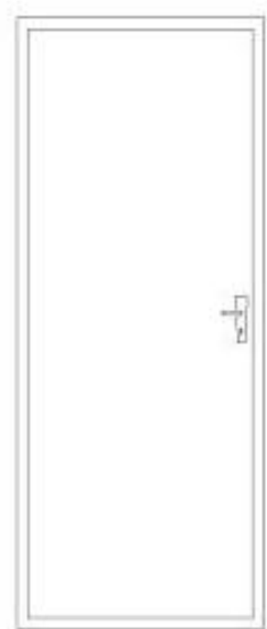
P2 porta interna esquerda 0,80x2,10 vista externa esc. 1/20
